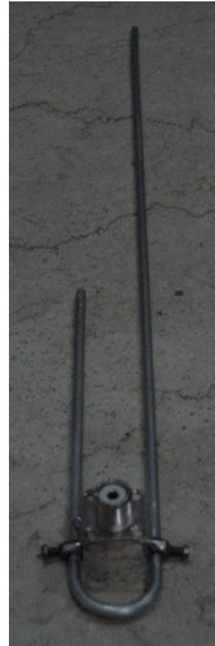
Antena J-Pole yang sudah selesai dibuat dan siap dituning dan digunakan.
