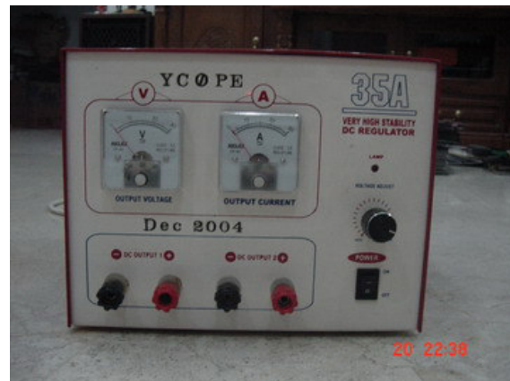
Tampak Depan PSA 13,8 Volt / 25A ( Pada Box tertulis 35A )
