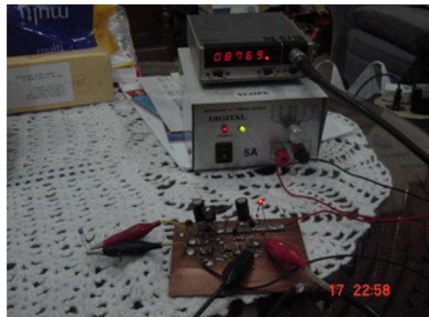
Pengukuran Inductor dengan bantuan Frequency Counter.
